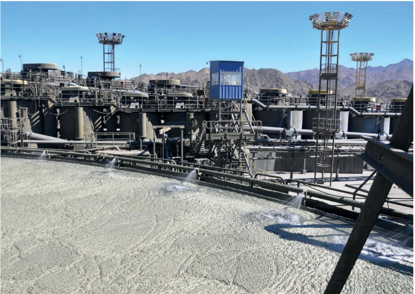
Los espesadores del concentrado se utilizan para alcanzar 65% de sólidos antes de ser bombeado por el mineraloducto.
