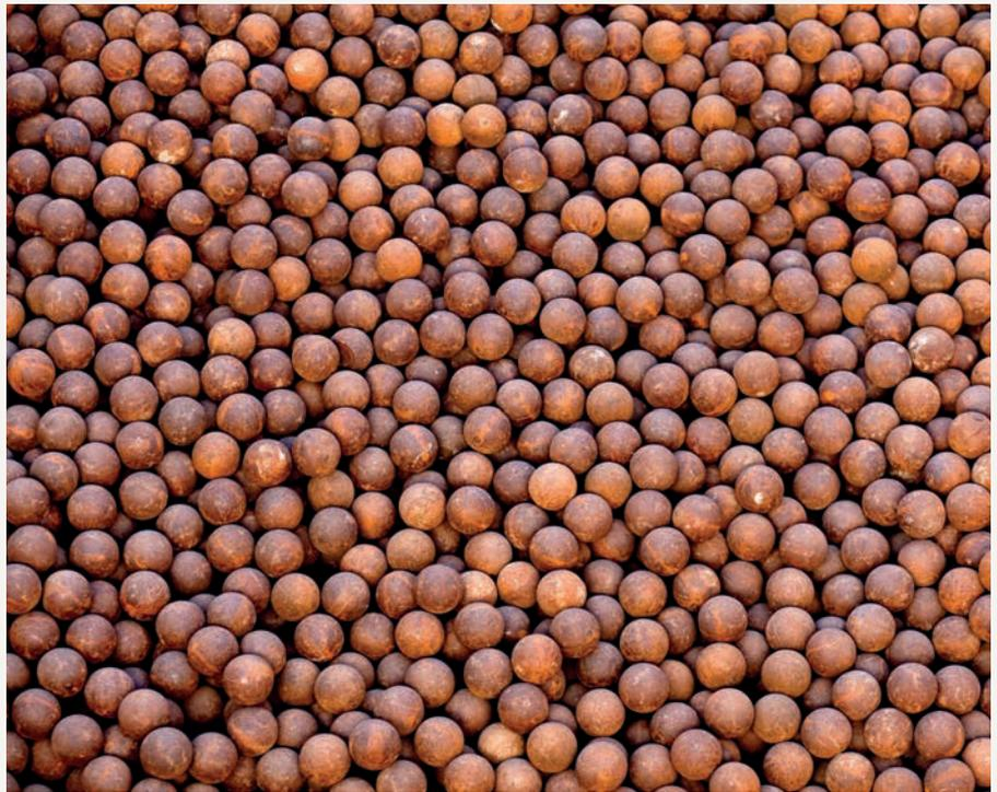
Las bolas de molino se utilizan para la trituración del mineral en la Planta Concentradora.
